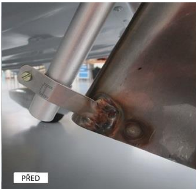
Obr. 1-1 Zobrazení problému odlomení původní konzoly L242.6674-00.17C
