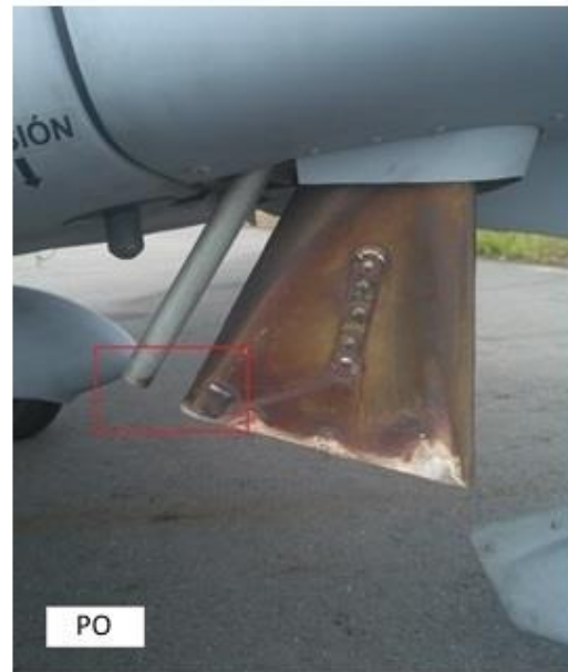
Obr. 1-1 Zobrazení problému odlomení původní konzoly L242.6674-00.17C
